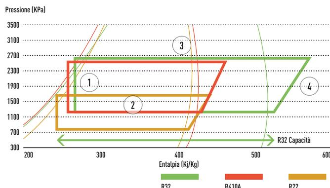
1. Espansione. 2. Evaporazione. 3. Condensazione. 4. Compressione.
